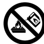
Füllen Sie keinesfalls im warmen Zustand Brennstoff ein.
