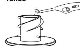
Se till att avståndet är tillräckligt stort när du tänds bränsle. Använd därför en braständare eller en lång tändsticka.
