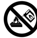
Fyld aldrig brændstof på i varm tilstand.
